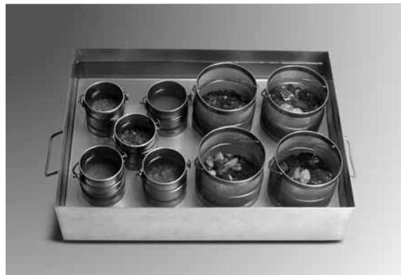
รูปที่ 2 ตัวอย่างที่แช่ในสารละลายโซเดียมซัลเฟต หรือแมกนีเซียมซัลเฟต
