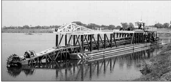
รูปที่ 3 เรือดูดทรายที่มี Capacity ในการดูดถึง 250 ตัน/ชม.
