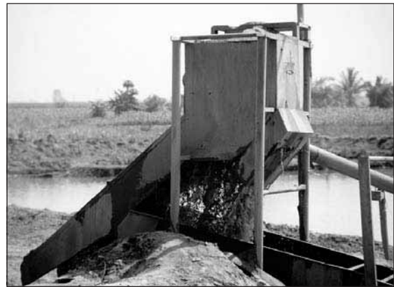
รูปที่ 2 การผลิตทรายตามวิธีการดั้งเดิมโดยใช้ตะแกรงแยกขนาดทราย
