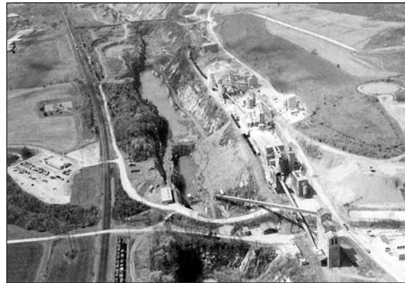
รูปที่ 6 การผลิตจากบ่อ (Open Pit Quarry)
