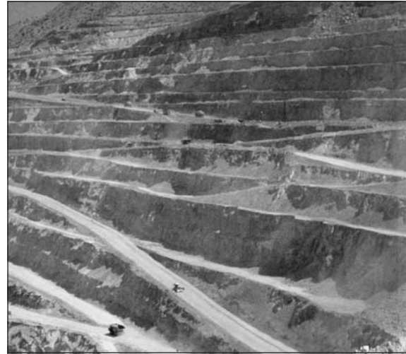
รูปที่ 5 การผลิตจากยอดเขา (Top Down Quarry)
