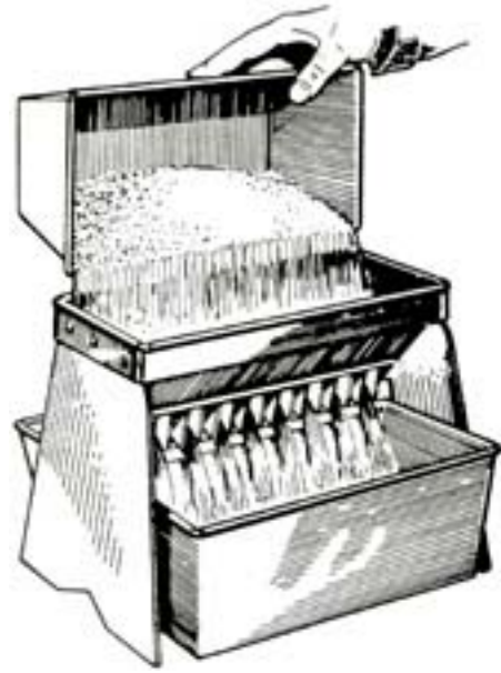
รูปที่ 3.23 การแบ่งส่วนตัวอย่างโดยใช้ Riffle Sampler
