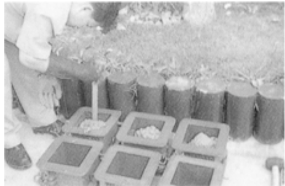
รูปที่ 19.4 การทำก้อนตัวอย่างเพื่อควบคุมคุณภาพ
