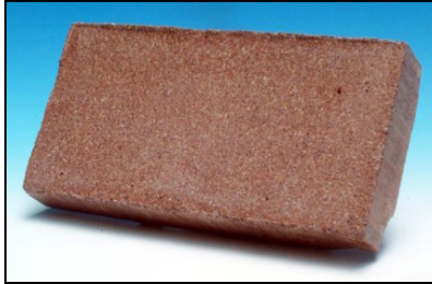
Fig.9 อิฐทนไฟซึ่งทำมาจาก metakaolin-geopolymer
