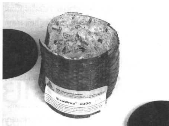
ลักษณะการวิบัติของลูกตัวอย่างที่ได้รับการเสริมกำลังสองชั้น
