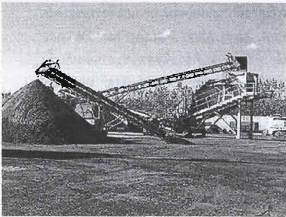
รูปที่ 4 กระบวนการผลิตมวลรวมที่นำกลับมาใช้ใหม่ ที่เมือง Copenhagen
