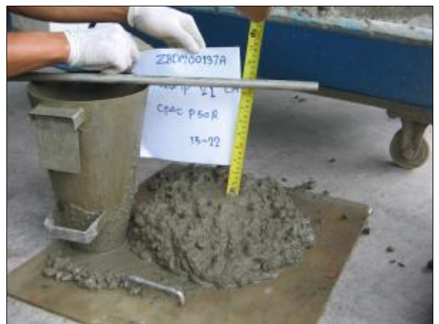
รูปที่ 8 การวัดค่า Slump ของคอนกรีตสำหรับเทได้น้ำ
