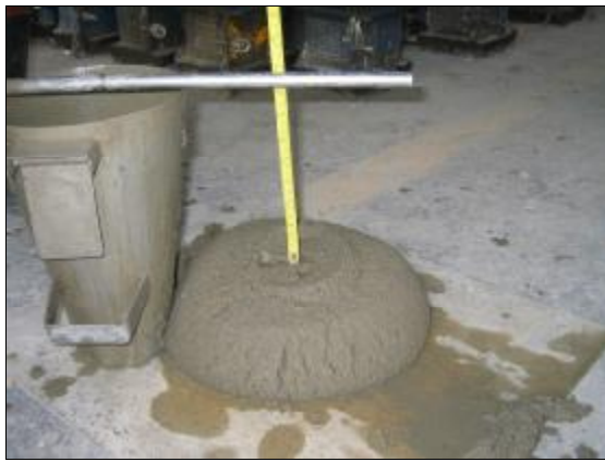
รูปที่ 24 การวัดค่า Slump ของ M2 : M00469A
