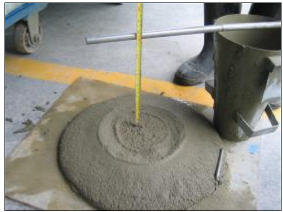
รูปที่ 27 การวัดค่า Slump ของ M1 : M0F006A
