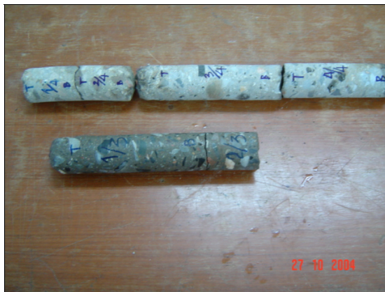
รูปที่ 15 ก่อน Coring ของคอนกรีตใต้น้ำที่เท
