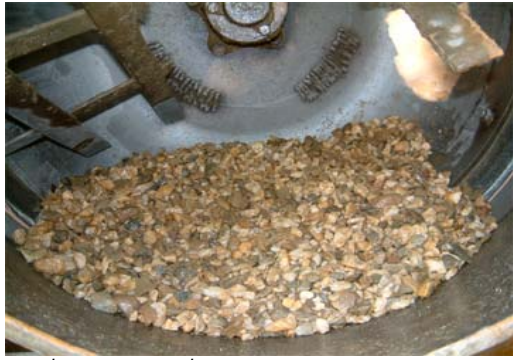
รูปที่ 9 กรวดไม้ที่ใช้ในการทดสอบส่วนผสมคอนกรีต
