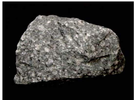
รูปที่ 25 แสดงลักษณะความเป็นมุมเหลี่ยม ของ หินไม่ที่มีอิทธิพลต่อแรงยึดเหนี่ยว ที่แข็งแกร่ง
