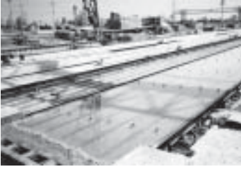
รูปที่ 10-7 การบ่มคอนกรีตด้วยวิธี การขังน้ำ ในโรงงานคอนกรีตสำเร็จรูป
