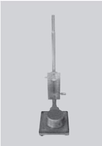
รูปที่ 3-22 การทดสอบระยะเวลาการก่อตัวของซีเมนต์เพสต์โดยใช้ Vicat Needle
