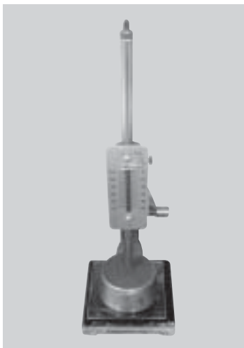
รูปที่ 3-20 การทดสอบความข้นเหลว โดยใช้ Vicat Plunger
