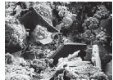
รูปที่ 3-7 ภาพถ่ายกำลังขยายสูงของซีเมนต์เพสต์ที่แข็งตัวแล้ว 8
