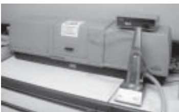
รูปที่ 3-18 แสดงการวิเคราะห์ขนาดอนุภาคปูนซีเมนต์ด้วยเครื่อง Laser Particle Size Analyzer
