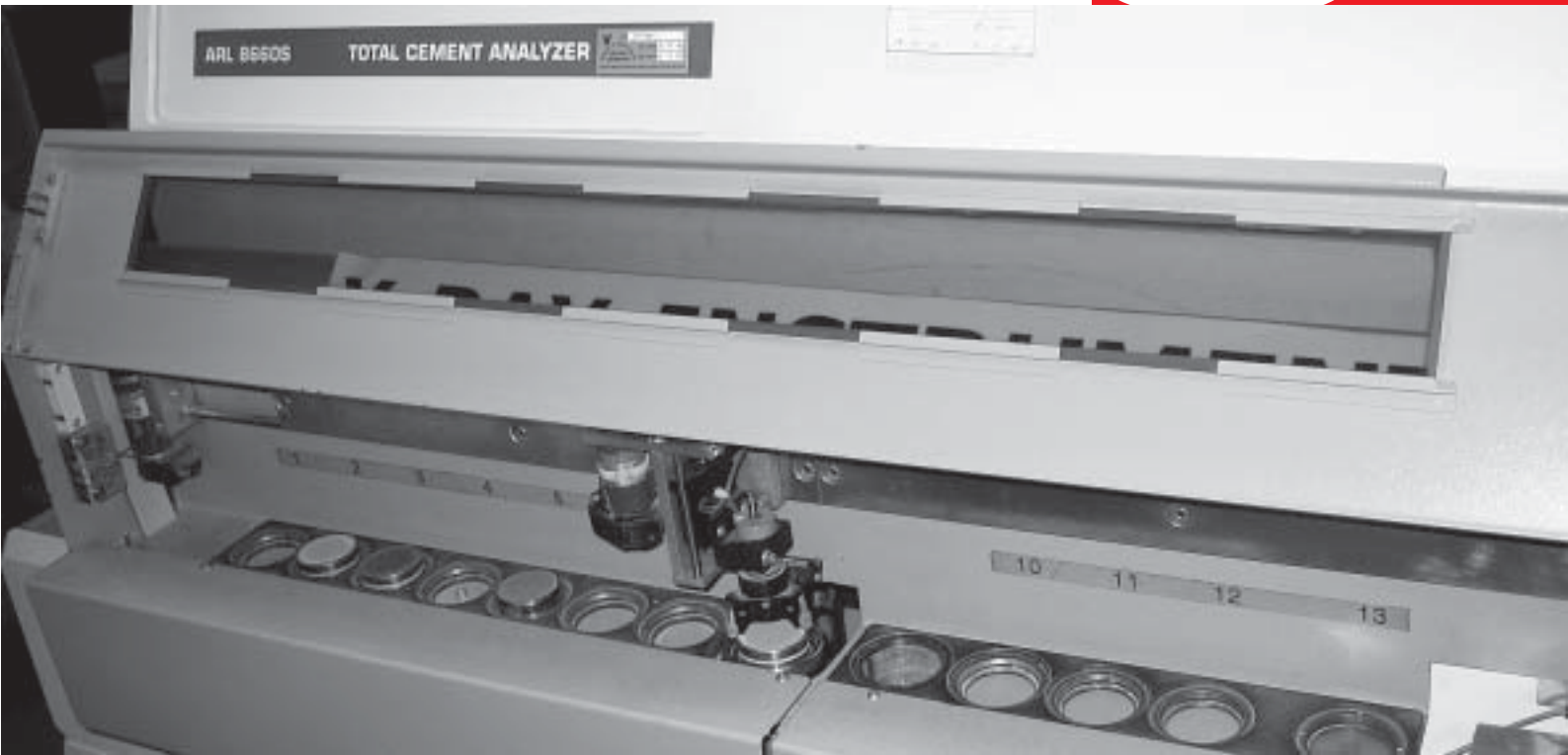
รูปที่ 3-1 เครื่องมือวิเคราะห์ทางเคมีของปูนซีเมนต์
