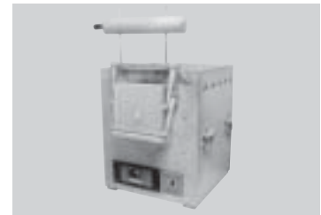
รูปที่ 3-13 เครื่องมือทดสอบหาการสูญเสียน้ำหนักเนื่องจากการเผาและกากที่ไม่ละลายในกรดและด่างของปูนซีเมนต์
