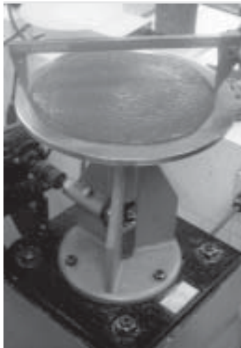
รูปที่ 3-21 การทดสอบค่าความข้นเหลวของมอร์ตาร์โดยใช้ Flow Table
