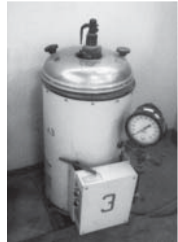
รูปที่ 3-19 การทดสอบความอยู่ตัว (Soundness) โดยใช้เครื่อง Autoclave ภายใต้อุณหภูมิและความดันสูง
