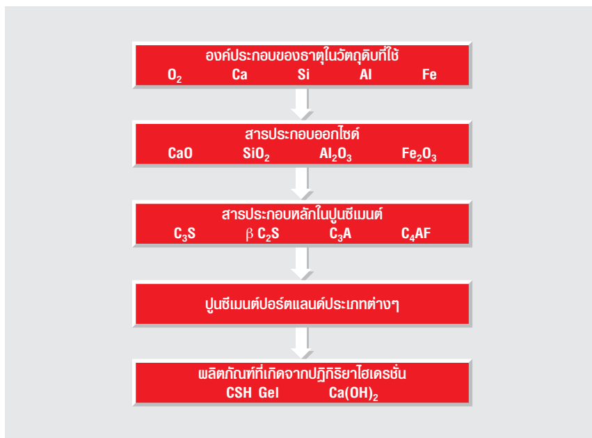
รูปที่ 3-2 แผนภาพแสดงความสัมพันธ์ของการผลิตและการเกิดปฏิกิริยาไฮเดรชันของปูนซีเมนต์
