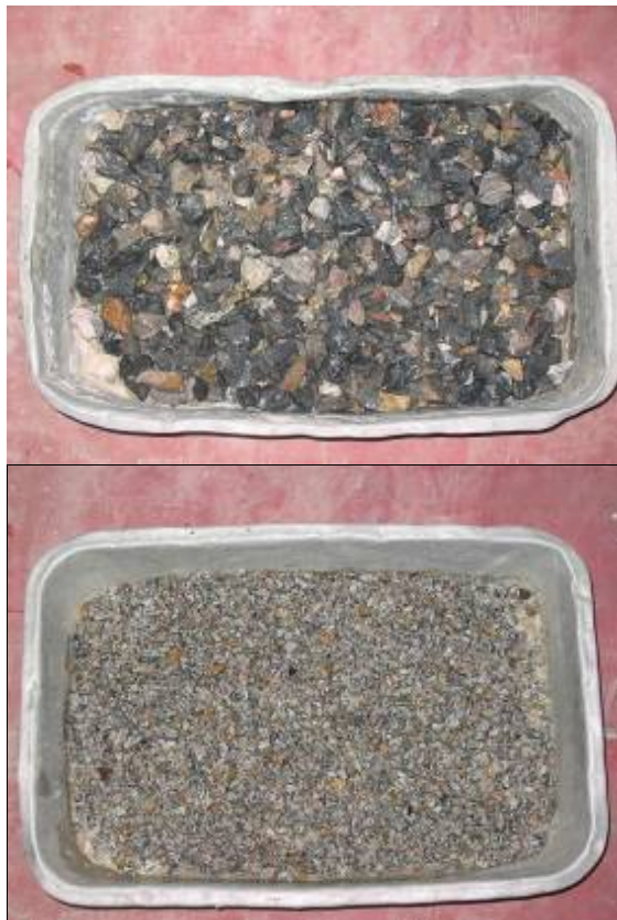
รูปที่ 3 เปรียบเทียบขนาดคละของหิน 3/4"- # 4 และ หิน 3/8"- # 8
