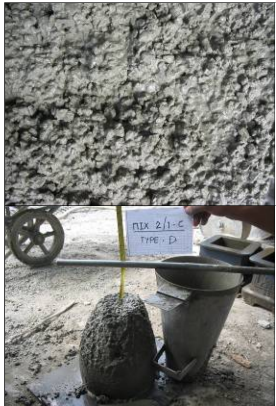
รูปที่ 4 สภาพเนื้อคอนกรีตที่ผลิตโดยใช้หิน 3/8"- # 8
