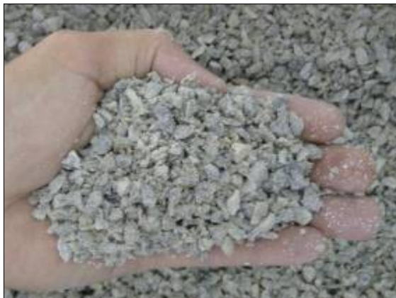
รูปที่ 5 หินจากโรงไม่ผู้ไทยที่มีปริมาณส่วนละเอียดสูง ทำให้ต้องใช้น้ำในการผสมมากขึ้นถึง 60 ลิตรต่อลบ.ม.
