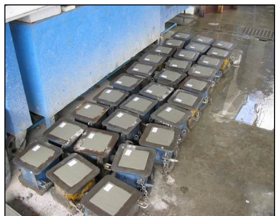
รูปที่ 7 การเก็บตัวอย่างเพื่อทดสอบกำลังอัด
