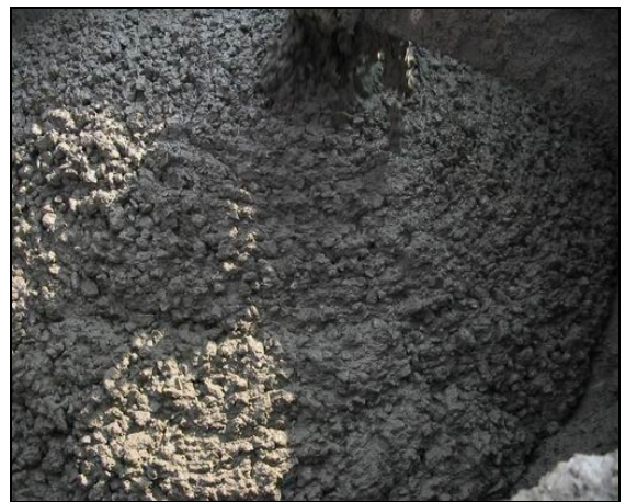
รูปที่ 22 สภาพเนื้อคอนกรีตที่ผลิตได้ถึงหน่วยงาน
