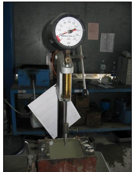
รูปที่ 6 การทดสอบระยะเวลาการก่อตัวของคอนกรีต
