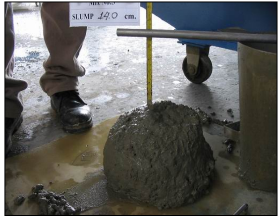
รูปที่ 5 การทดสอบค่ายุบตัวของคอนกรีต
