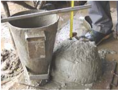
รูปที่ 14 ค่ายุบตัวเบื้องต้น 14.0 ซม. คอนกรีตกำลังอัด 240 กก./ตร.ซม.
