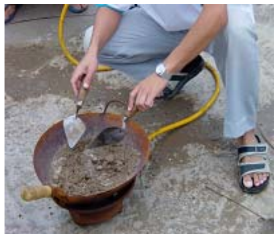
รูปที่ 12 การหาความชื้นกรวดและทรายโดยวิธีการคั่ว
