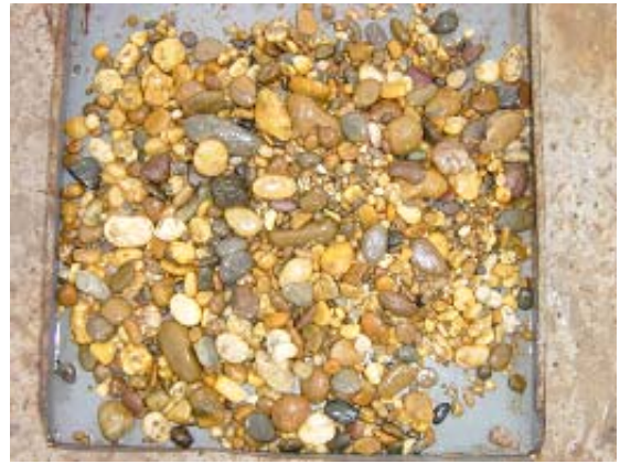
รูปที่ 11 แสดงกรวด จ.นครพนมที่มีค่าพื้นที่ผิวจำเพาะ 2,693 ตร.ซม./กก.
