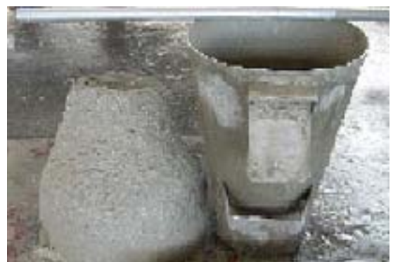
รูปที่ 6 ลักษณะเนื้อคอนกรีตและค่ายุบตัวเริ่มต้นทดแทน PFA 20% ได้ค่ายุบตัว 11.0 ซม.
