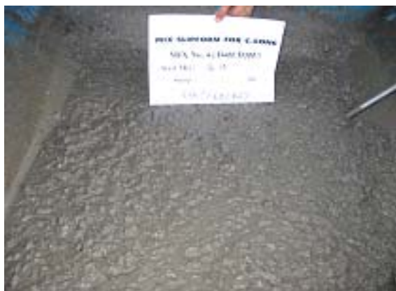
รูปที่ 12 ตัวอย่างสภาพเนื้อคอนกรีตของแต่ละส่วนผสม และการวัดค่า Slump
