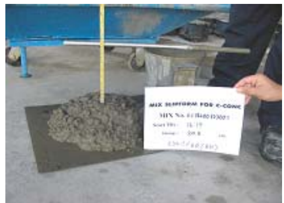
รูปที่ 12 ตัวอย่างสภาพเนื้อคอนกรีตของแต่ละส่วนผสม และการวัดค่า Slump
