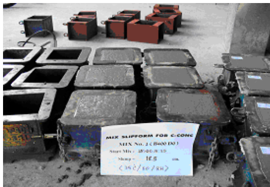
รูปที่ 9 การเก็บก่อนปูนตัวอย่าง เพื่อทดสอบหาค่ากำลังอัดของคอนกรีต
