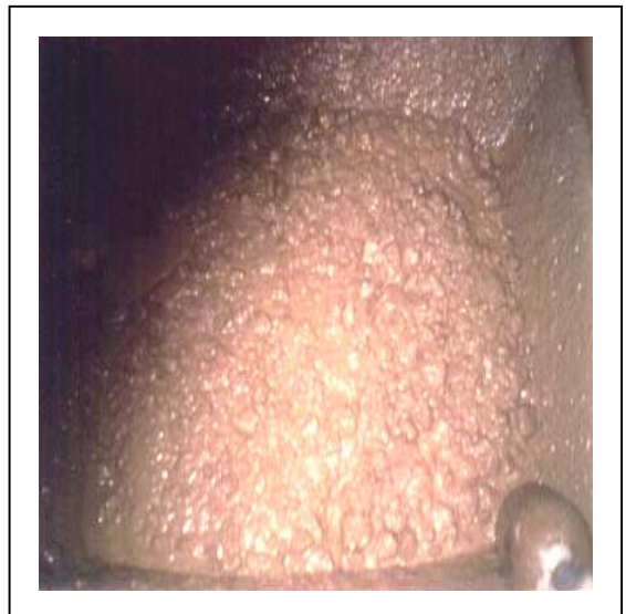
รูปที่ 3 ลักษณะเนื้อคอนกรีตสดของ M18A400T
