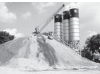
รูปที่ 17-15 คอนกรีตผสมเสร็จ มีการกองเก็บหิน ทราย และปูนซีเมนต์ไว้ที่โรงงาน จึงช่วยแก้ปัญหางานก่อสร้างที่มีบริเวณก่อสร้างจำกัดได้
