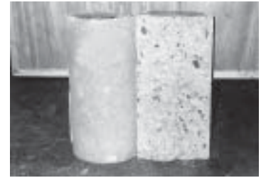
รูปที่ 16-3 ก้อนตัวอย่างจากการทดสอบกำลังดึงของคอนกรีตโดยวิธี Splitting Tensile Strength Test จะแตกในแนวตั้งตามแนวเส้นผ่านศูนย์กลาง
