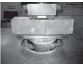
รูปที่ 16-2 ลักษณะการแตกร้าวของตัวอย่างรูปคาน จากการทดสอบกำลังดัดของคอนกรีต (Flexural Strength Test)
