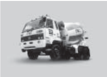
ก) รถคอนกรีตผสมเสร็จ เหมาะสำหรับงานก่อสร้างทุกขนาด โดยเฉพาะงานขนาดกลาง และขนาดใหญ่
