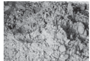
ข) เนื้อคอนกรีตสดของ RCC มีลักษณะแห้งมาก
