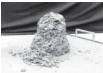
รูปที่ 12-5 ส่วนผสมคอนกรีตที่มีอัตราส่วนทรายต่อมวลรวมทั้งหมดต่ำเกินไป จะเกิดการแยกตัวได้ง่าย
