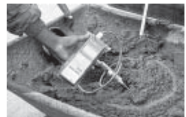
รูปที่ 12-28 การวัดอุณหภูมิของคอนกรีต เพื่อเป็นข้อมูลประกอบการวิเคราะห์ร่วมกับคุณสมบัติอื่น ๆ ของคอนกรีต
