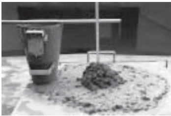
รูปที่ 12-9 คอนกรีตสดเกิดการแยกตัว เนื่องจากมีการออกแบบส่วนผสมคอนกรีตไม่เหมาะสม
