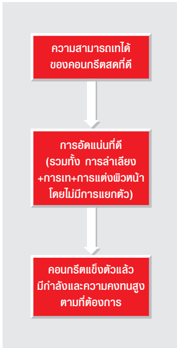
รูปที่ 12-2 คุณสมบัติของคอนกรีตสดส่งผลโดยตรงต่อกำลังและความคงทนของคอนกรีตแข็งตัวแล้ว
