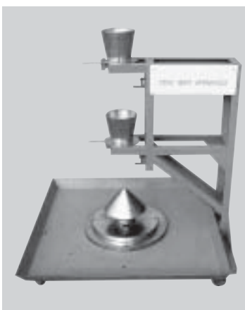
รูปที่ 12-10 เครื่องมือทดสอบความต้านทานต่อการแยกตัวของคอนกรีตสด "CPAC SERT Apparatus" นวัตกรรมด้านเครื่องมือทดสอบคอนกรีต (ที่มา : คอนกรีตผสมเสร็จซีแพค)
