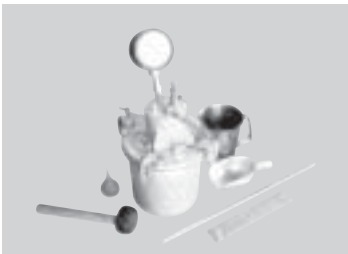
รูปที่ 12-42 อุปกรณ์ทดสอบปริมาณอากาศ
