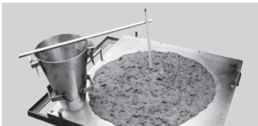
รูปที่ 12-7 ลักษณะเนื้อคอนกรีตสดที่เหลวมากด้วยน้ำยาผสมคอนกรีต มีเนื้อสม่ำเสมอ มีการยึดเกาะดี และไม่เกิดการแยกตัว
