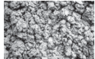
รูปที่ 12-6 เนื้อคอนกรีตสดมีลักษณะแห้ง และมีความสามารถเทได้ต่ำ เนื่องจากคอนกรีตเริ่มก่อตัวและเกิดการสูญเสียน้ำไปบางส่วน
