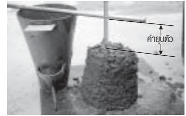
รูปที่ 12-31 การวัดค่ายุบตัว
