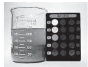
รูปที่ 9-57 การทดสอบสารอินทรีย์เจือปนในทราย
