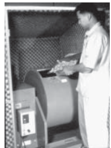
รูปที่ 9-56 เครื่องทดสอบแรงเสียดทานสำหรับทดสอบความต้านทานการกัดสีของมวลรวม
