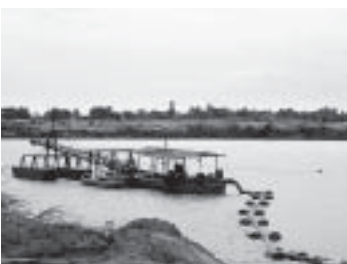
รูปที่ 9-27 ท่อส่งลำเลียงทรายจากเรือเข้าสู่ Feedbox
