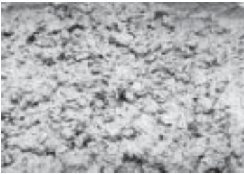
รูปที่ 8-2 คอนกรีตสดที่ดี ควรมีความชื้นเพียงพอเหมาะกับการใช้งานมีเนื้อสม่ำเสมอ และไม่แยกตัว
