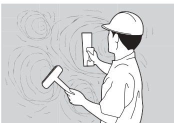
รูปที่ 7-20 การบั่นแห้งด้วยเกรียงไม้ เพื่อให้ผิวผนังเนียนและแห้ง แทนที่วิธีการลงฟองน้ำ จะช่วยให้ปูนฉาบคงทนและไม่เป็นฝุ่น
