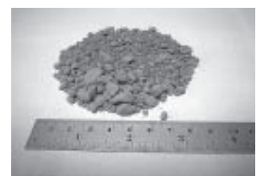
รูปที่ 7-5 ลักษณะปูนซีเมนต์จับตัวเป็นก้อน ซึ่งเกิดจากรีการกองเก็บปูนซีเมนต์ที่ไม่ถูกวิธี
