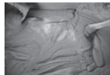
รูปที่ 7-14 ลักษณะเนื้อปูนฉาบที่มี ความชื้นเหลวเหมาะสม มีความเหนียวยืดเกาะดี
