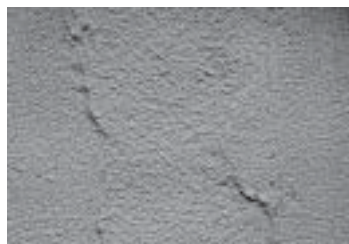
ก) เนื้อปูนฉาบที่มีการยึดเกาะกันดี รูปที่ 7-16 คุณสมบัติการยึดเกาะของเนื้อปูนฉาบ
