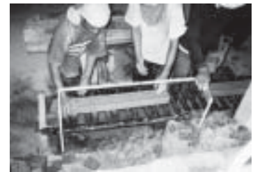
ข) การตัดอิฐเป็นก้อน ๆ ด้วยสวด
