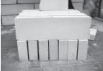
รูปที่ 5-19 คอนกรีตมวลเบาหรืออิฐมวลเบา
