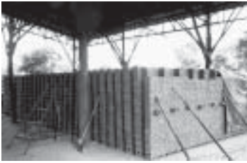
รูปที่ 5-11 ลักษณะการเรียงอิฐในเตาเผาจะเรียงให้มีช่องระบายความร้อนได้อย่างทั่วถึง
