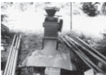
รูปที่ 5-22 เครื่องตีดินลูกรัง 2
