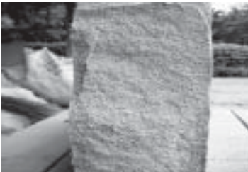
รูปที่ 5-20 รูพรุนในเนื้อคอนกรีตมวลเบา
