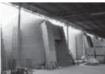
ข) เตาเผาอิฐแบบถาวร (ใช้พื้นเป็นเชื้อเพลิง)
