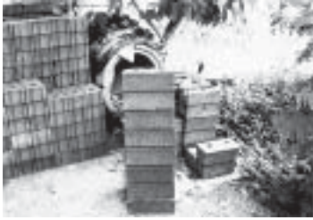
รูปที่ 5-21 อิฐประสาน หรืออิฐดินซีเมนต์ 2
