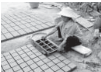
ก) การขึ้นรูปอิฐ โดยใช้ไม้แบบที่เรียกว่า "ลอง"
